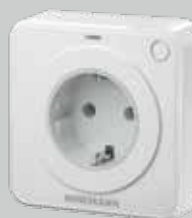
Приемник ДУ в розетке FES 1 BS для включения и выключения света и других потребителей эл. тока, до 2500 Ватт FES 1-1 BS для управления (импульс) приводами других фирм-изготовителей, а также для включения и выключения света или других потребителей эл. тока, до 2500 Ватт
