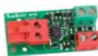
Шинный интерфейс XIB (для платы E045, или E045S, или E024S с фотоэлементом без подключения к шине) 790062
