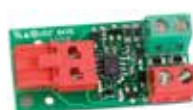
Шинный интерфейс XIB (для платы E045, или E045S, или E024S с фотоэлементом без подключения к шине)
