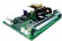
Электронная плата 624BLD (встроена в систему автоматики)
