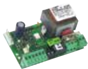
Электронная плата 540BPR (встроена в систему автоматики)
