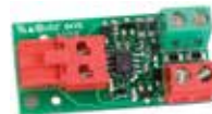
Шинный интерфейс XIB (для платы E045, или E045S, или E024S с фотоэлементом без подключения к шине)
