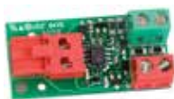
Шинный интерфейс XIB (для платы E045, или E045S, или E024S с фотозлементом без подключения к шине) 790062
